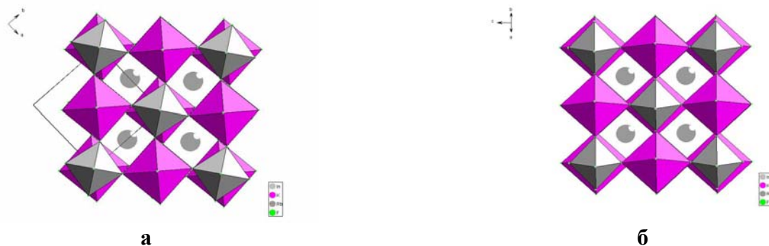
Рис. 2. Структура тетрагональной фазы Rb_2KInF_6 при температуре T = 270 К: а – проекция вдоль оси четвертого порядка, б – проекция вдоль оси a_0 исходной фазы. Символ искажения – (0,0,\phi)
