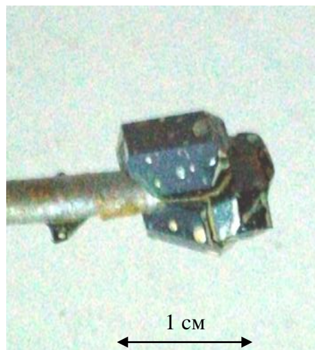
Рис. 2. Монокристаллы \text{SmFe}_3(\text{BO}_3)_4 , выращенные в режиме с предварительным спонтанным зарождением ограниченного числа кристаллов в тонком слое раствора-расплава
