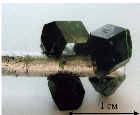
Рис. 3. Монокристаллы \text{NdFe}_3(\text{BO}_3)_4 , выращенные на затравках в малом объеме раствора-расплава
