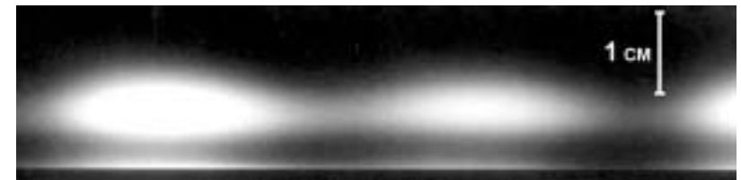
Рис. 8. Фоторазвертка стоячих волн интенсивности излучения плазмы разряда. Отверстие центрального электрода \sim 4.0 мм. Сила тока 10 А. Скорость потока аргона 32 м/с.
